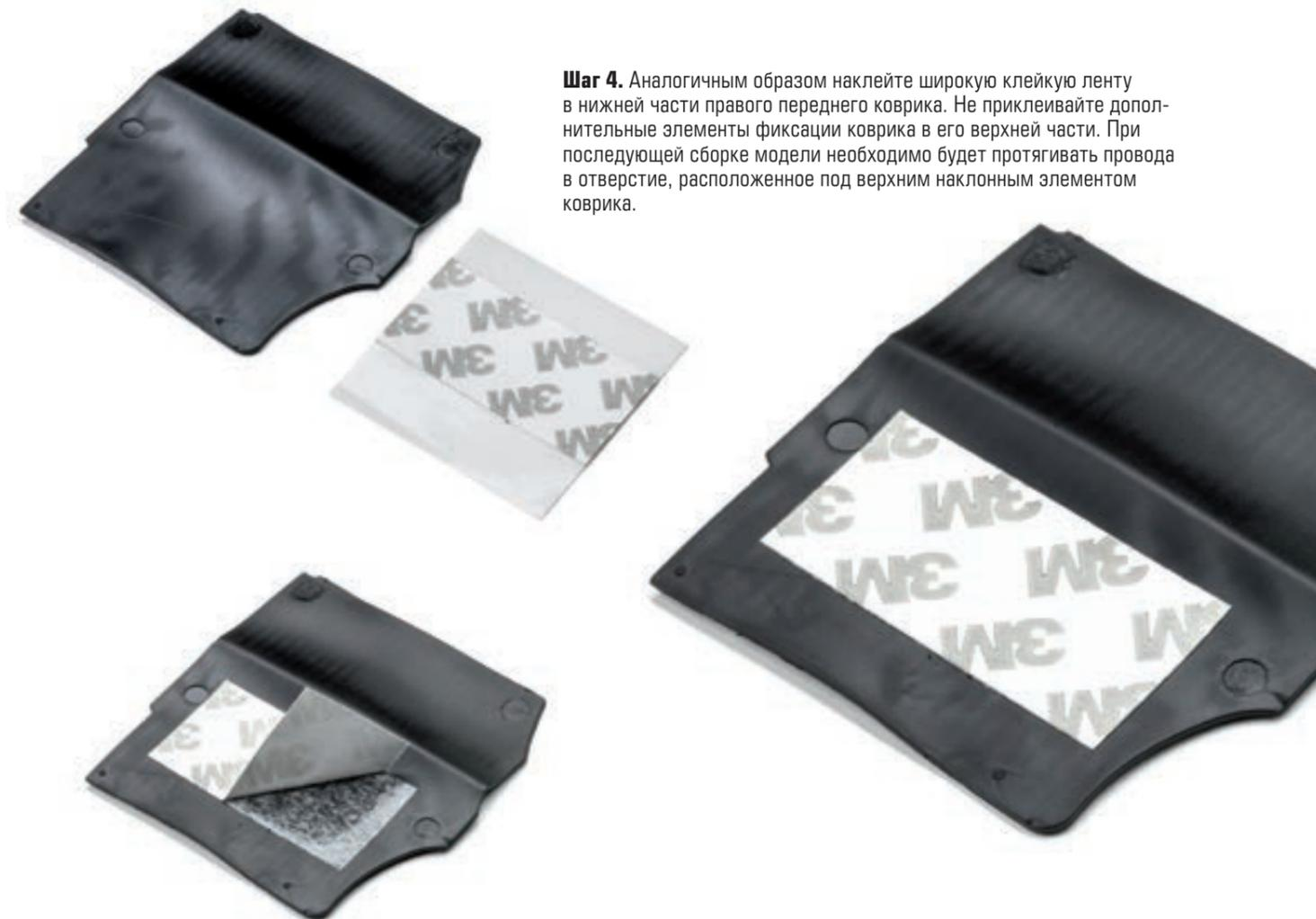
**Шаг 4.** Аналогичным образом наклейте широкую клейкую ленту в нижней части правого переднего коврика. Не приклеивайте дополнительные элементы фиксации коврика в его верхней части. При последующей сборке модели необходимо будет протягивать провода в отверстие, расположенное под верхним наклонным элементом коврика.
