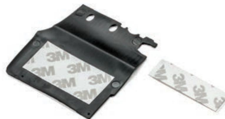
**Шаг 2.** Наклейте узкую полосу клейкой ленты в верхней, более узкой части левого переднего коврика. Обратите внимание: полоса клейкой ленты не должна перекрывать отверстия под педали и вырезы под элементы управления автомобилем.
